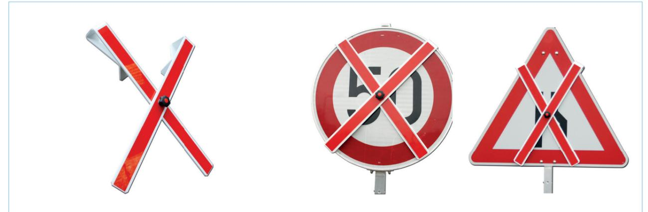
Die Mobile Auskreuzvorrichtung Typ 1 dient zum Auskreuzen von Verkehrszeichen der Größe 2, bestehend aus 2 witterungsbeständigen Kunststoffleisten. Die Kreuzstellung wird durch einen Sterngriff gehalten, **beklebt mit Folie Typ RA3/C mit Schutzlaminate**.
