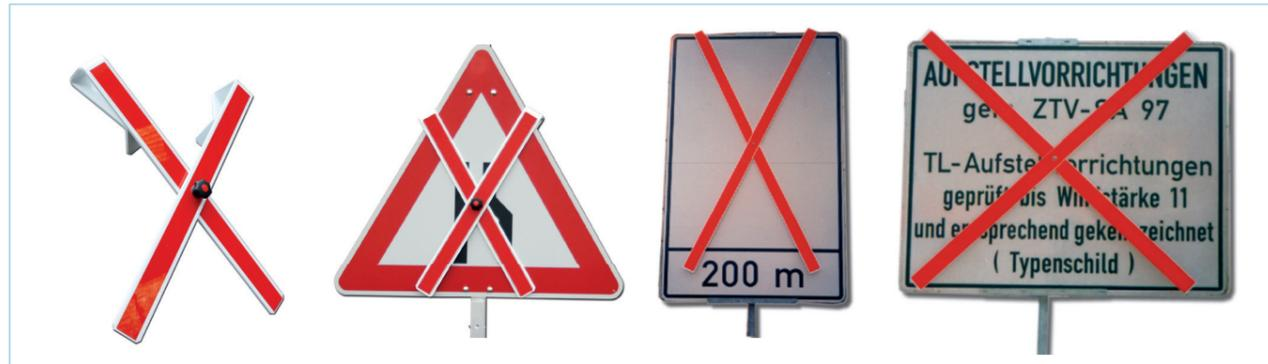
Die Mobile Auskreuzvorrichtung Typ 2 dient zum Auskreuzen von Verkehrszeichen der Größe 3, Dreiecke, Ronden, Zusatzzeichen, Tafeln und Ankündigungsbaken, bestehend aus 2 witterungsbeständigen Kunststoffleisten. Die Kreuzstellung wird durch einen Sterngriff gehalten, **belebt mit Folie Typ RA3/C mit Schutzlaminat.**
